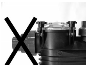
Nie stosować redukcji na poziomie wlotu/wyjścia.
