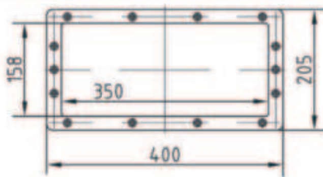
Kołnierz do przedłużenia 100 mm z poszerzeniem 350 mm, kod 1046050
